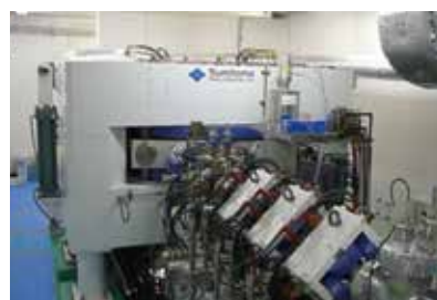
加速器BNCTシステムで用いられているサイクロトロン
