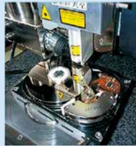
磁気力顕微鏡でハードディスクを観察している様子
